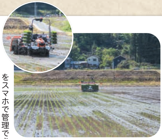
自動田植え機による作業。事前に田植え前の田んぼを走らせGPSによって面積を記憶させます。無人状態で苗が重なることなく一直線に植えられていきます。
