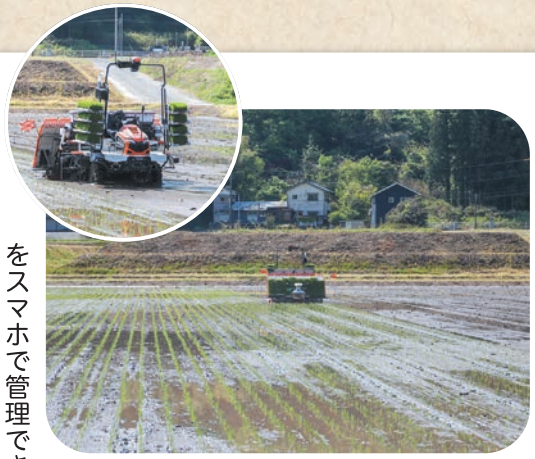
自動田植え機による作業。事前に田植え前の田んぼを走らせGPSによって面積を記憶させます。無人状態で苗が重なることなく一直線に植えられています。
